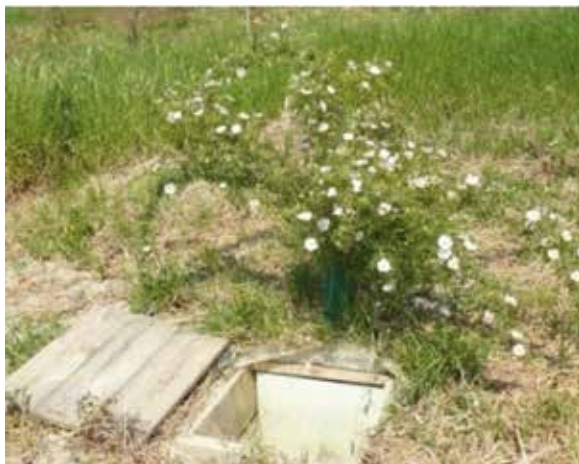
Figura 5.5.2 Rizotrone installato in corrispondenza di un esemplare di Rosa canina
